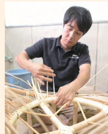
**巻き**／骨組みに縦方向に丸芯（丸藤の芯の部分）を巻き付け、座の部分に丸藤を取り付けます。
