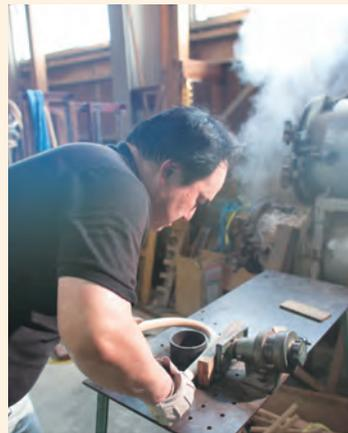
**曲げ**／火で炙ったり、蒸したりしながら、ラタンを曲げて、各パーツを作っていきます。あらかじめパーツごとに作ってある三次元の型枠（治具）などを使って形を固定させます。
