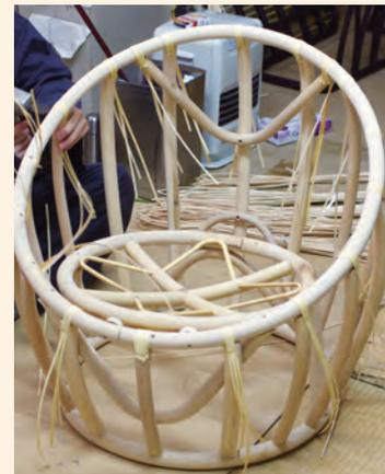
**組み立て**／各部材を釘や木ネジなどで組み立てて骨組み全体の形を整えます。入手しづらい太い直径のラタンを使用している為、安定感があります。
